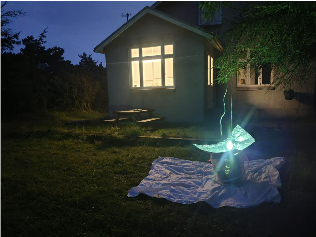
125W kviksølvfælde i stationshaven. Selve opsætningen er simpelt bygget af en vasketøjskurv fra IKEA således at den kan foldes helt sammen, samt en foldbar tragt jeg har bygget af foldbar PVC-plast som jeg har beklædt med spejlfolie.
